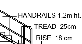
STAIRCASE DETAILS (N.T.S.)
