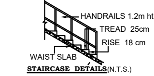
STAIRCASE DETAILS (N.T.S.)
