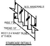
STAIRCASE DETAILS SCALE: 1:20
